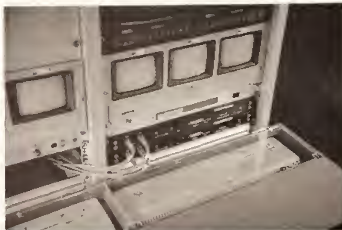
Aus Platzgründen sind die Computer senkrecht in die Tische eingelassen. Für die Fahrt werden sie extra gesichert.
